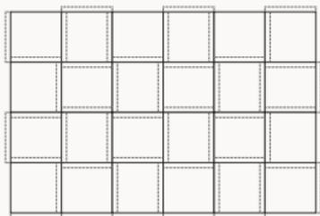
Zur Befestigung der Platten sind handelsübliche Dämmstoffhalter\* zu verwenden. Um eine ebene Untersicht ohne Faltenbildung (Matratzeneffekt) zu erzielen, sollten die Dämmstoffhalter nur bis zur Plattendicke eingeschlagen oder geschraubt werden.
