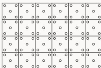
Dieser Anordnung zufolge werden 5 Dübel pro Platte benötigt (3,47 Dübel/m<sup>2</sup>).
