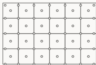
Bei Plattendicken von 60 bis 100 mm empfehlen wir Dübelteller mit 80 mm Durchmesser und bei Plattendicken von 120 bis 160 mm Dübelteller mit 110 mm Durchmesser.
